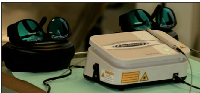
Figura 1. Visión global de nuestro equipo de terapia fotoactiva: láser diodo, jeringa de azul de metileno y gafas protectoras.
